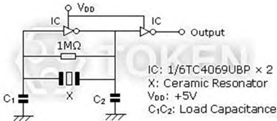
KHz (ZTB) Test Circuit for MOS IC
