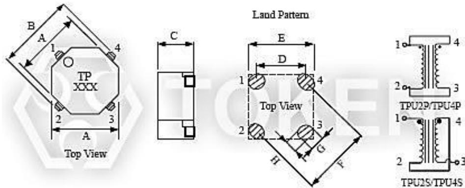
貼片功率環型電感器 (TPUTX-2P/2S/4P/4S) 尺寸圖 (Unit: mm)
