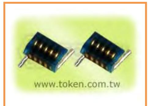
空芯線圈 (TRAM) 貼片系列，具有高自振頻率，在高頻率範圍內具有高 Q 值，及穩定的電感量。同時，低直流阻抗的設計，有利於降低功耗，損耗低，高輸出。廣泛的電感值 3.9~538 nH，方便設計人員選擇最適合的應用器件。
