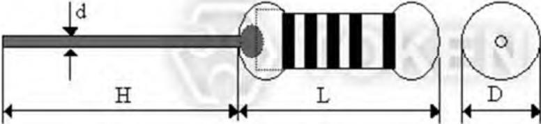
精密金屬膜電阻 (RJ) 尺寸圖
