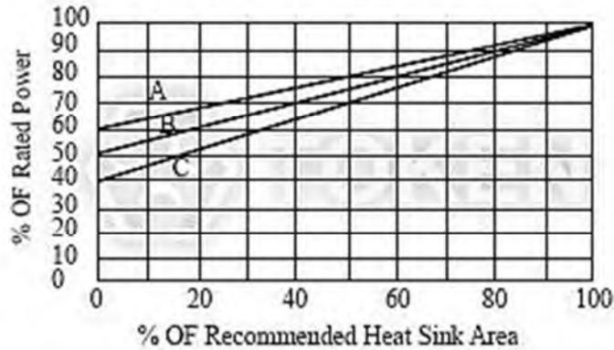
功率鋁盒電阻 (AH) 散熱片 降額曲線
