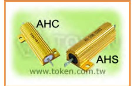
德鍵電子黃金鋁盒電阻器 AH 系列，因其功耗大，體積小，具有耐氣候性，工作溫度範圍  $-55^{\circ}\text{C} \sim +275^{\circ}\text{C}$ ，常作為大功率型電阻使用，如煞車電阻器、老化電阻器、鋁外殼散熱電阻器、制動電阻器、泄放電阻器。
