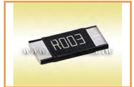
與其他金屬合金電流檢測電阻器製造商不同，德鍵金屬合金貼片電阻 (LRE) 具有一系列優勢，功率高達 5W，低阻值範圍 0.25mΩ to 1Ω 溫度係數 ±50 ppm/°C；，多樣封裝尺寸 0805/1206/2010/2512/2725/2728/2817/4527 可供選擇，適用於需要高功率處理的應用。依產品尺寸大小，提供每卷 1Kpcs, 2Kpcs, 4Kpcs, 5Kpcs 標準的卷盤包裝，方便使用於自動裝配工藝。
