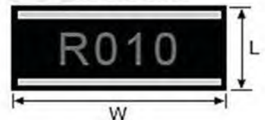
貼片低阻毫歐電阻 CS 系列 尺寸圖
