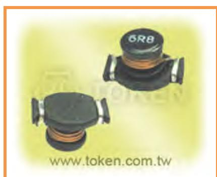
TPU1813DHP 採用先進的繞線技術，堅固耐用的直接線端之構造可實現大電流，較低的直流阻抗 DCR 和小於 5.0mm 的厚度。TPU1813DHP 的電感值為 0.18 μH to 100 μH，額定電流高達 14.00 A。
