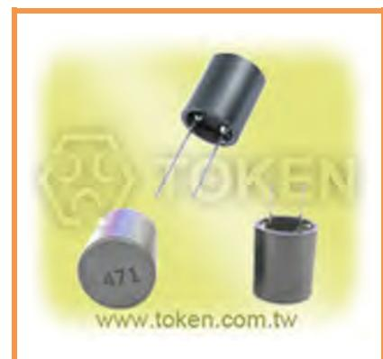
德鍵 (TCRCS) 系列阻流線圈規格齊全，具有品質因素好，共振頻率高，可獲得較大的感應電流，漏磁小等優點。阻流線圈電感 (TCRCS) 採用開磁路構造設計，用 PVC 或 UL 热縮套管保護，有立式和臥式結構，有結構性佳、體積小、高 Q 值、低成本等特點，適用於筆記型電腦、噴墨印表機、影印機、顯示監視器、手機、寬頻數據機、遊戲機、彩色電視、錄放影機、攝影機、微波爐、照明設備、汽車電子產品等。
